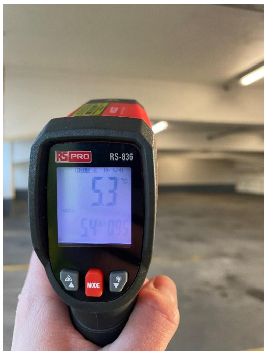
Figur 1: Temperaturmåling på undersiden af dækket mellem stuen og første sal d. 2. marts.
