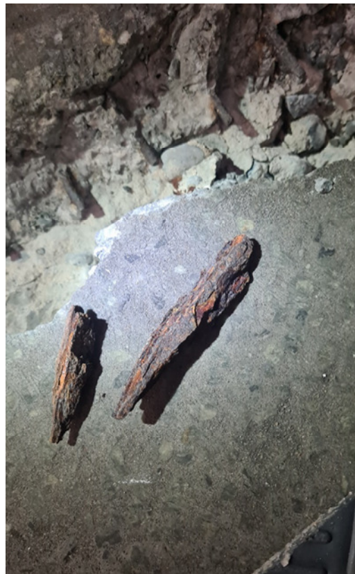
02/ Samme sted, rustflager udtaget af armeringen.
